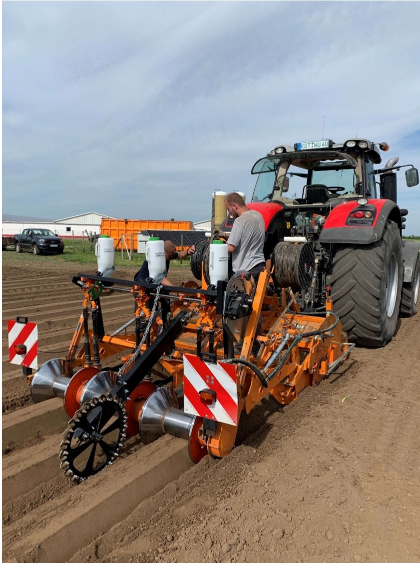
Abbildung 1: Sämaschine für Möhren von Gut Mennewitz GmbH entwickelt
